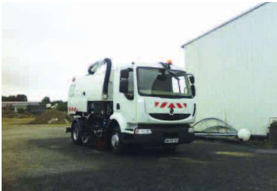
Pour assurer le nettoyage, la Ville a procédé à l'achat d'une balayeuse mécanisée. Cet équipement, installé sur un châssis de camion, combine par la puissance de son moteur, un balayage et une aspiration plus efficace. Ce véhicule autorise aussi une plus
