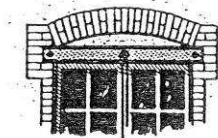
lintheau métallique, sous un arc de décharge en briques
